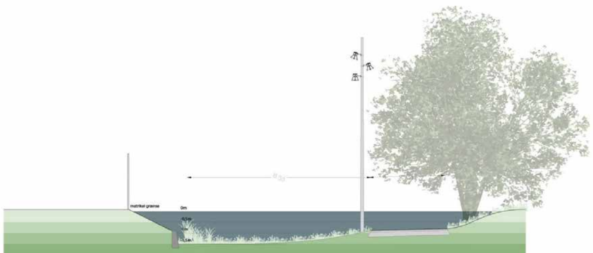
Figur 6.15. Foreløbige skitser fra ideoplæg til grøn cykelrute i Amagerbanens østlige tracé. Her vises forslag til hvordan den nordlige del af tracéet kan indrettes med en støttemur i den ene side af arealet, så der kan opstuve meget vand i hele tracéet. Skitser: Gruppe F.
