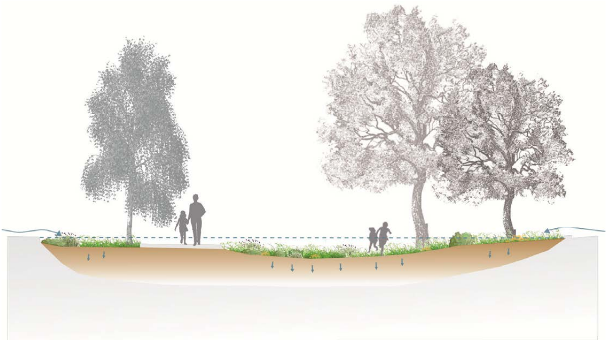
Figur 6.16 Tværsnit af typisk blå/grøn skybrudspark. Bemærk at der stort set altid vil være mulighed for noget nedsivning på sådanne arealer med mindre en kendt jordforurening begrænser det. Skitse: Gruppe F.
