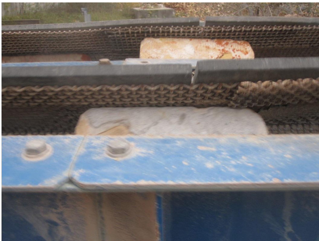
Figur 6. Foto visende den maskinelle renseproces af mursten hos firma Gamle Mursten
