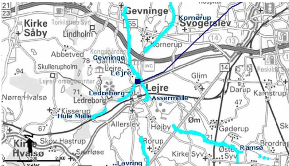
Figur 11 Lejre Vandværk med tilhørende kildepladser.
