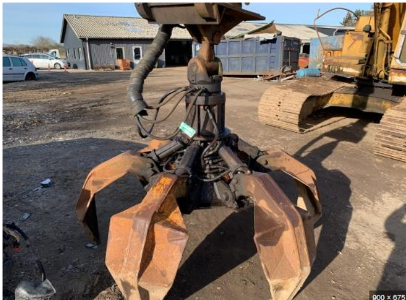
Figur 3. En polygrab, som kunne være et eksempel på en passende skovl til projektet.
