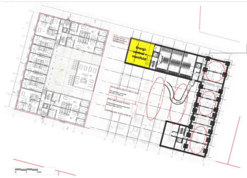
Figur 2 Placering af borerne (inden for de røde polygoner)
