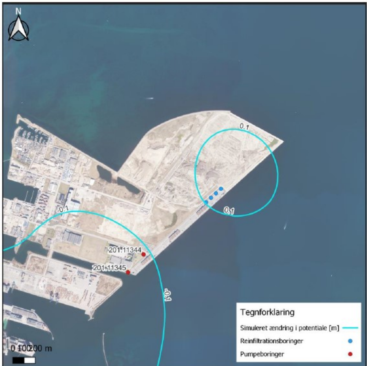
Figur 6 Modelleret påvirkningen af potentialet i Øvre Københavnerkalk. Stigningen i potentialet i Øvre Københavnerkalk er konservativt beregnet til 10 cm, og påvirkningsradius er ca. 500 meter mod nordøst.
