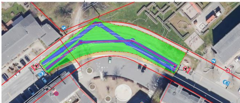
Figur 5. Eksempler på trafikafviklingsplan. Grøn: arbejdsareal. Mørkeblå: ledningsgrav.
