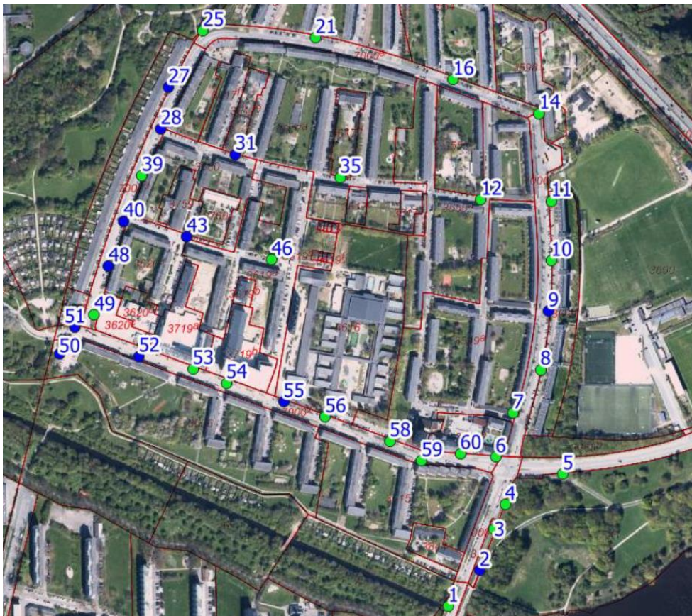
Figur 4 Placering af geo- og miljøtekniske boringer
