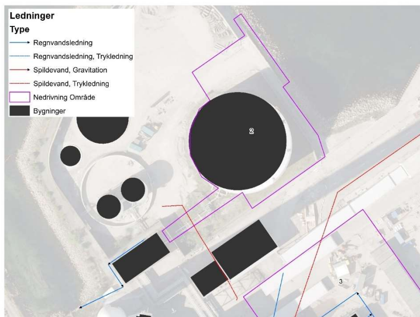
Figur 15 Tank 3 og Tankgårdsmur – Ledninger i og omkring området.
