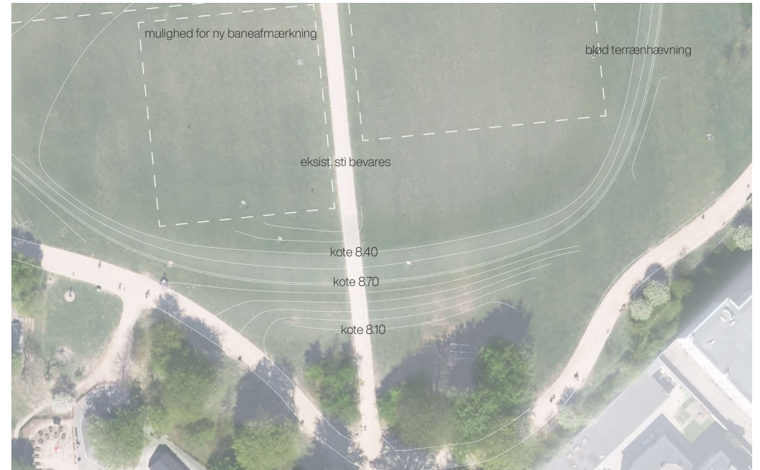
Figur 15 Skybrudsbassin på Blegdamsfælled
