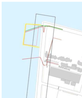
Figur 2. Principsskitse, der viser placering af flåde (rødt rektangel i havnebassinet) og siltgardin (med gul strek).
