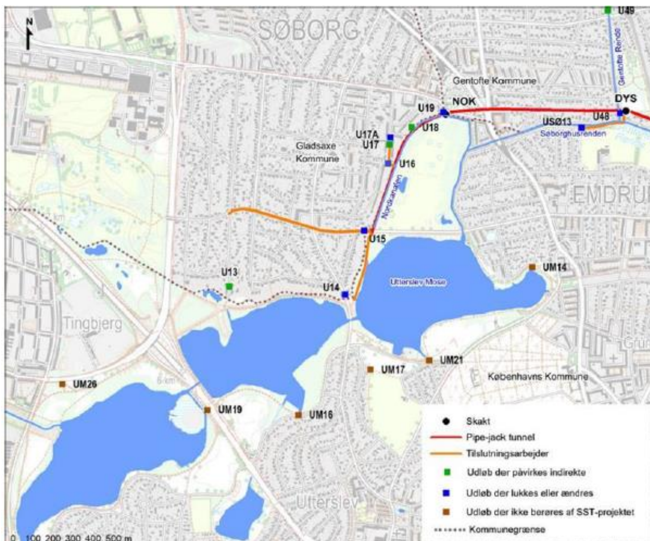
Figur - - Oversigt over Utterslev Mose, Nordkanalen, Gentofterenden og Søborghusrenden samt udledningspunkterne til disse vandområder. De blå og grønne udlob påvirkes af Svanemøllen Skybrudstunnel.
