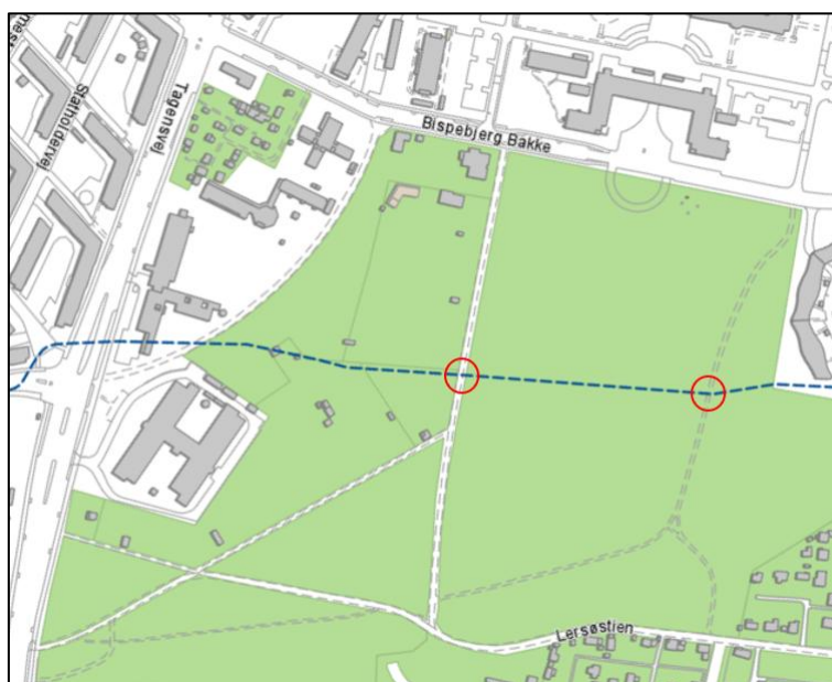
Figur 1. Oversigtskort over den rørlagte del af Lygte Å, som løber tværs gennem Lersøparken parallelt med Bispebjerg Bakke og Lersøstien. Den rørlagte strækning, er markeret på blå, og de to røde cirkler repræsenterer de to steder hvor renderne fra skybrudsprojektet vil krydse det rørlagte vandløb.
