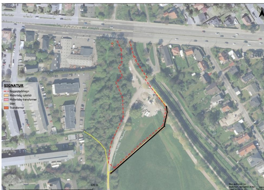
Figur 3, Kort over stisystemet, der løber langs byggepladsen ved DEN. Den sorte linje angiver det stisystem, som udføres på skruefundament. Stien, som er markeret med en tynd gul linje, er for gående og er eksisterende stisystemet og bliver ikke udført med skruefundament.
