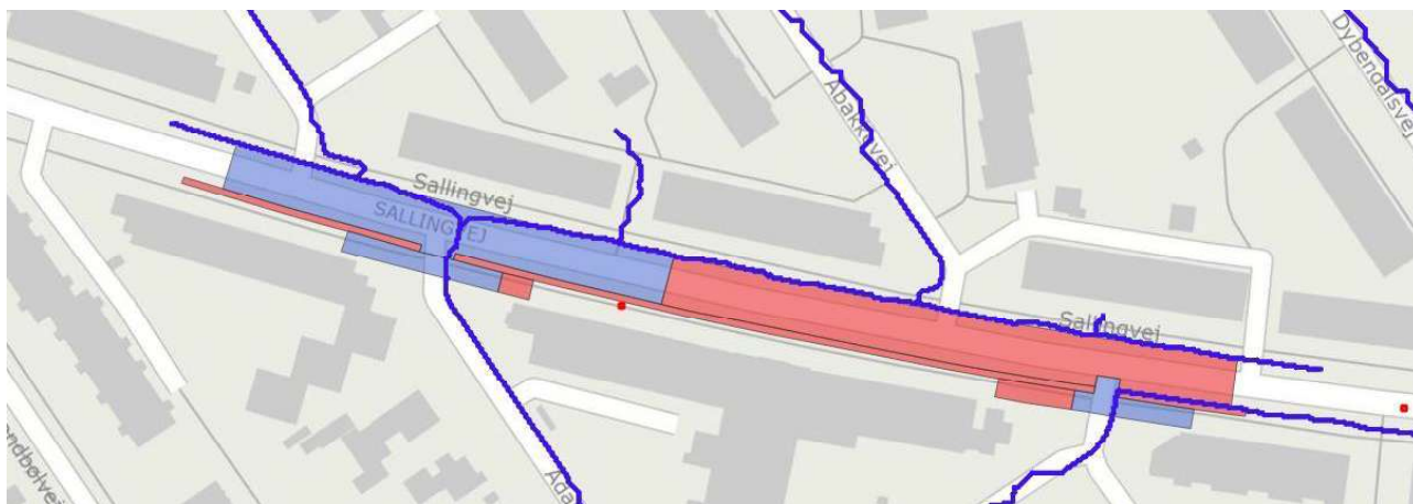
Figur 11: Skitse af ændringer for vejgeometrien på Ådalsvej. Blå områder skal sænkes og røde område skal hæves. Her også vist med strømningsveje (mørkeblå) for den nye vejgeometri beregnet i SCALGO.
