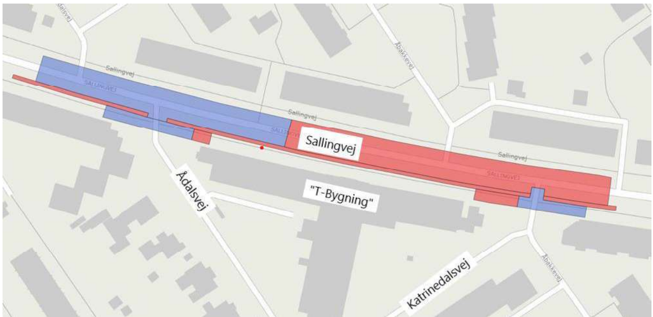
Figur 9: Skitse af ændringer for vejgeometrien på Sallingvej. Blå områder skal sænkes lidt og røde område skal hæves lidt. Eventuelle småjusteringer til vejkotter (vurderes under 10 cm) af nordligst del af Ådalsvej og Katrinedalsvej afklares ved detailkoter.
