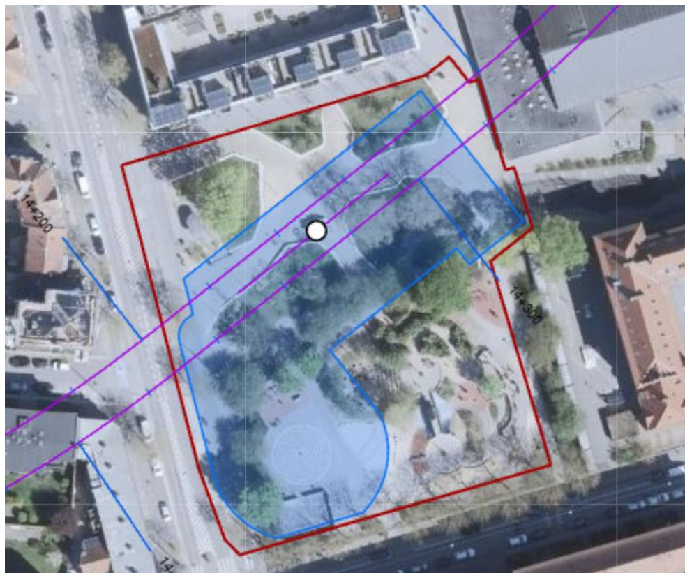
Figur 2-2 Ændret byggepladsareal og byggegrube ved Sundbyøster Plads med underjordisk cykelparkering.
