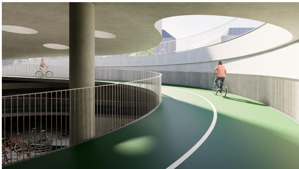
Figur 3-8 Spiralformet rampe fra terræn til cykelparkering.
