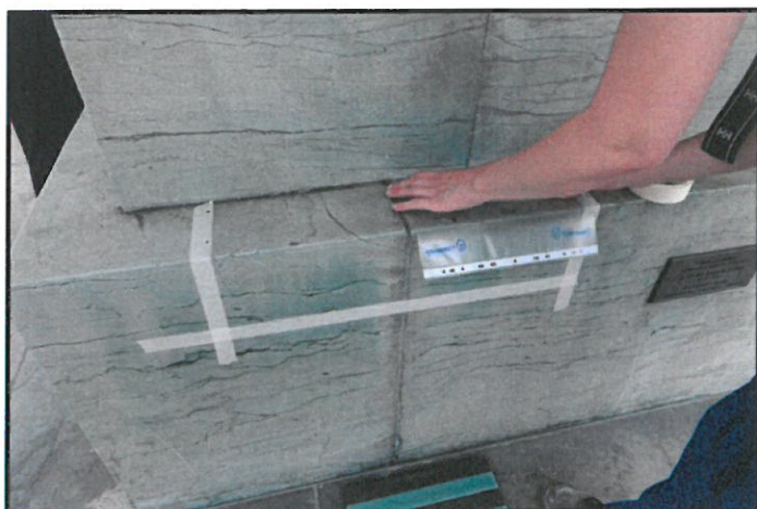
Foto 24: Seir-Materialeanalyse foretager farvemålinger for afrensning af marmoren.
