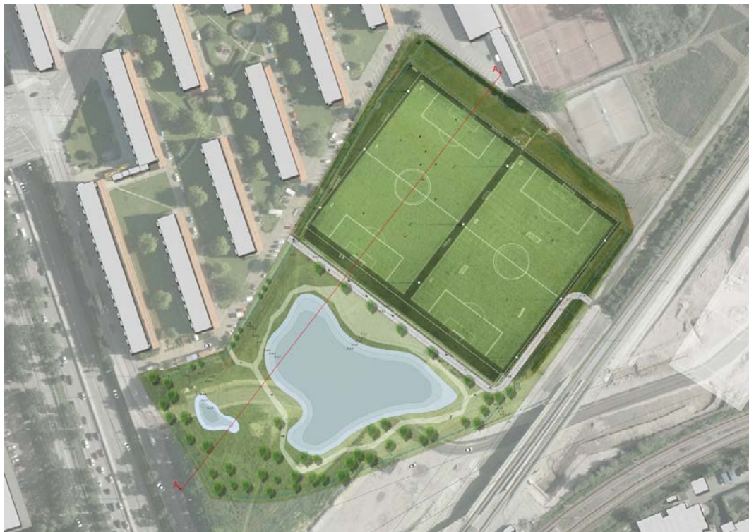
Figur 5-12 Ryparken - vejvandssø og skybrudsbassin efter etablering af vandtunnel til Svanemøllebugten. Regnvandsbassinet er vist med vandspejl, som det vil se ud et stykke tid efter regn, når bassinet er tømt ned til niveauet for det permanente vandspejl. Under skybrud vil vandspejlet stå højere end vist og oversvømme et areal omkring vejvandssøen og i en ekstrem situation også boldbanerne (skybrudsbassinet).
