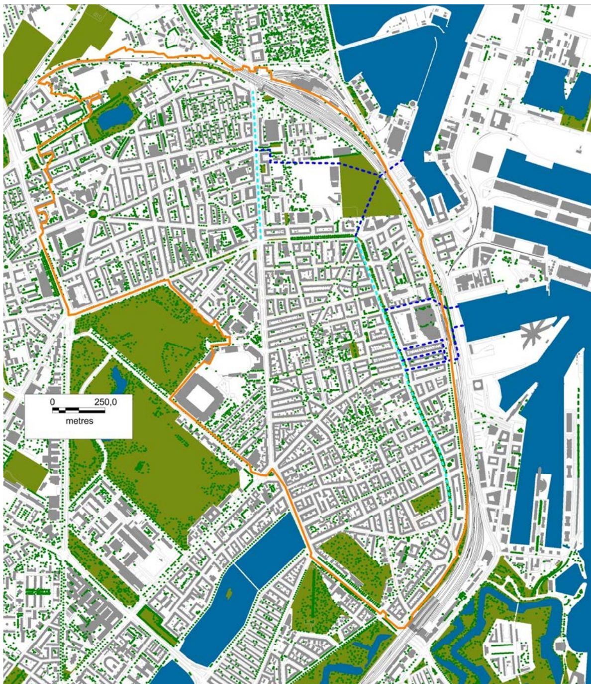
Figur 6-9 Overordnet skybrudsledninger bestående af opsamlingsledning i Østerbrogade og Strandboulevarden og tunnel/udløb til havnen.
