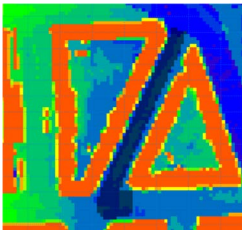
Figur 6-32 Løgstørgade. Højtliggende områder er vist med rødlige farver; lavtliggende områder er vist med blå-lilla farve. Terrænet er sænket ml. 5 og 10 cm i det mørkt markerede område.
