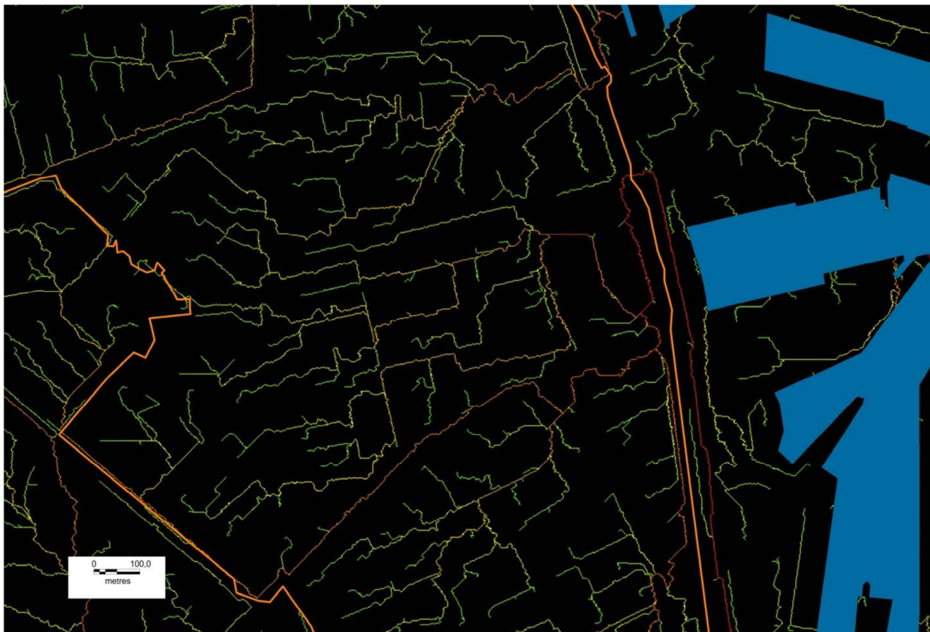
Figur 5-4 Strømningsveje på Ydre Østerbro Nordlige område fra Jagtvej til Nordre Frihavnsgade. Strømningsvejene går fra grøn mod rød.
