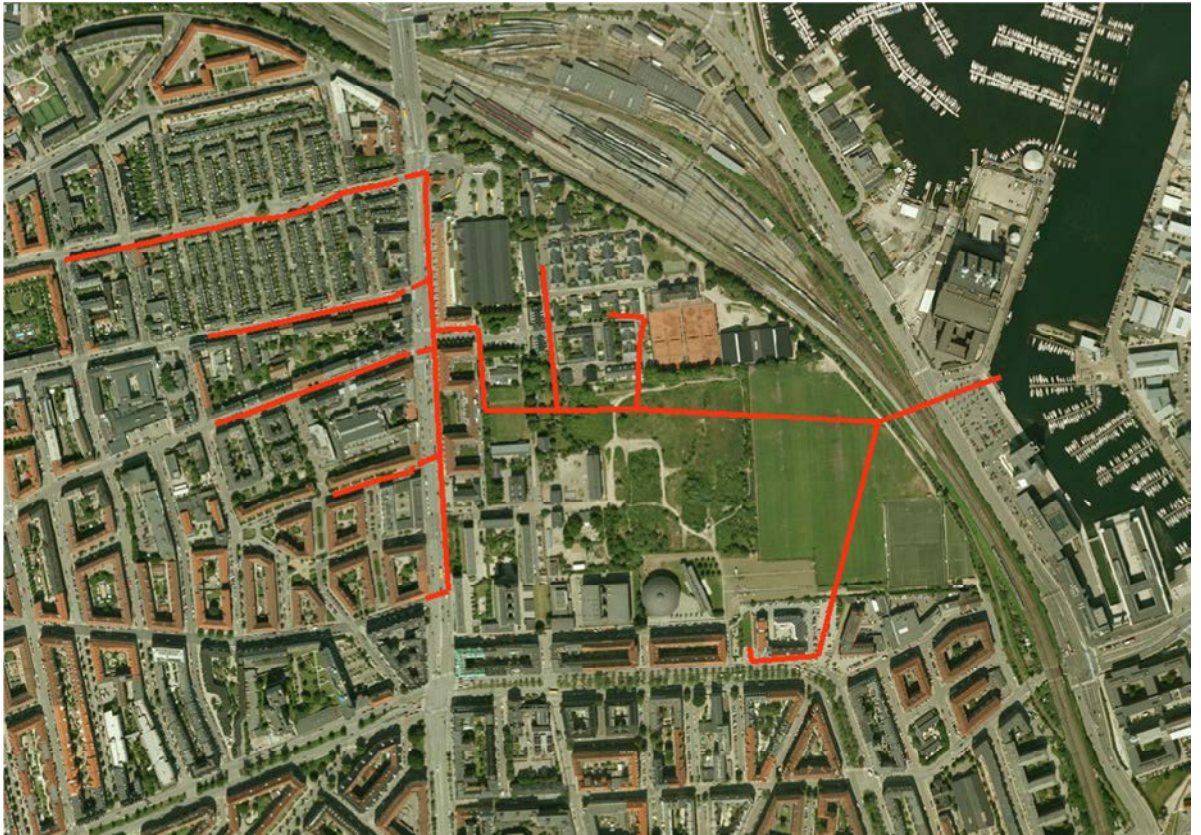
Figur 6-15 Skybrudsledninger til Ydre Østerbro. Skybrudsledningerne vil også fungere i daglig drift som separatsystem for afledning af tag- og fortovsvand.
